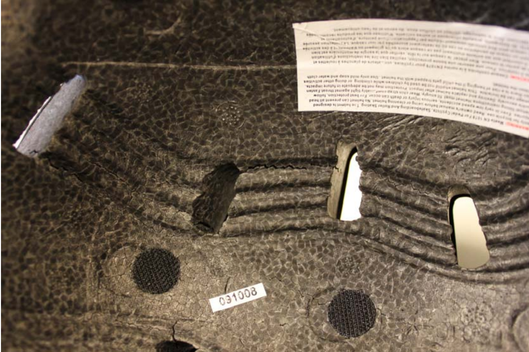
Bild 2: Bruch der Decke des verwendeten Helms
